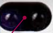
Optisk øje til aflæsning og konfiguration
